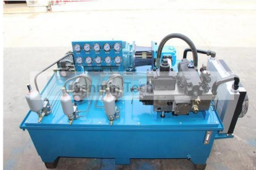
Eine Maschine ist mit einem Hydraulikaggregat ausgerüstet. Dieses besitzt 3 hydr. Speicher (Blasenspeicher) mit einem Inhalt von 6 Liter, Betriebsdruck 330 bar.
