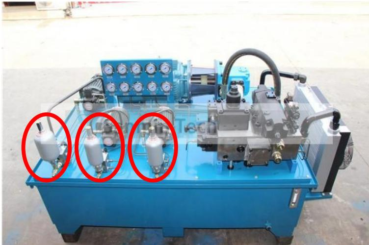
Es handelt sich um Druckluft oder ein anderes inertes Gas (z.B. Stickstoff) im Blasenspeicher. Handelt es sich um Druckluft, so wäre das Gefahrgut, welches im Gegenstand enthalten ist, «UN 1002 Luft, verdichtet (Druckluft)»
